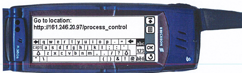
รูปที่ 2.15 WAP Emulator ของ Ericson R380 ที่ทำงานเดียวๆ
