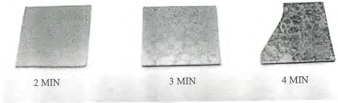
รูปที่ 7.20 ภาพถ่ายแผ่นซิลิคอนที่ถูกทดลองสร้างชั้นพอร์ซซิลิคอน โดยการจุ่มลงในสารละลายภายใต้แสงจากหลอดHalogen โดยใช้สารละลายที่มีอุณหภูมิประมาณ 60 องศาเซลเซียส ที่เวลาต่างๆ
