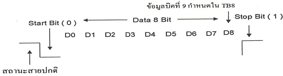
รูปที่ 3.6 แสดงสัญญาณของการส่งข้อมูลของโหมด 2 และ โหมด 3
