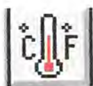
รูปที่ 3-10 แสดงสัญลักษณ์ของตัวรับสัญญาณเข้าทางอุณหภูมิ
