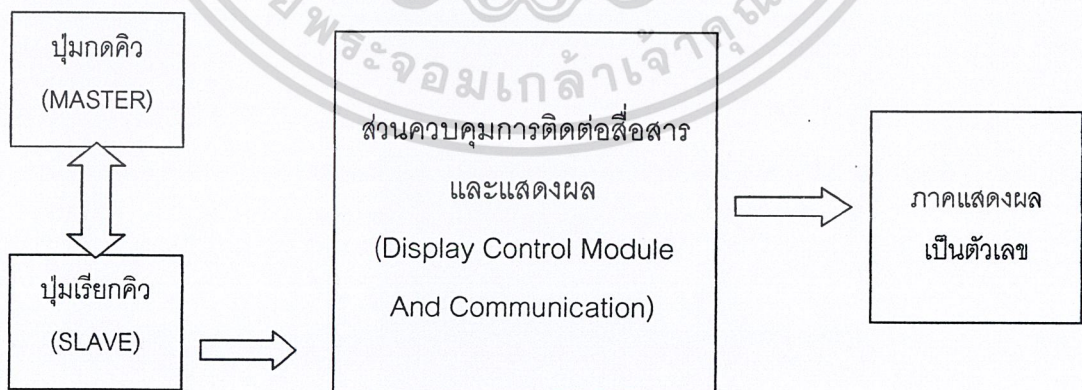
ภาพที่ 1.1 บล็อกไดอะแกรมแสดงการทำงานของระบบคิวอัตโนมัติ
