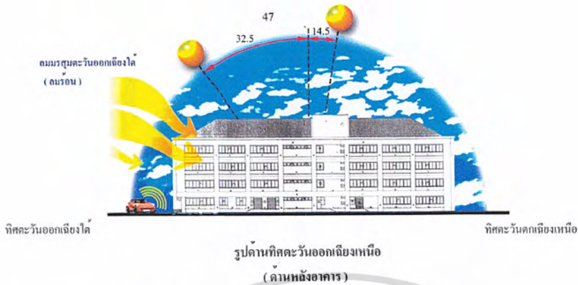
ภาพที่ 4.9 แสดงผลกระทบต่อตัวอาคารทางทิศตะวันออกเฉียงใต้และทิศตะวันตกเฉียงเหนือ
