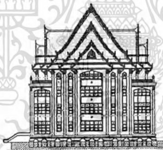
ภาพที่ 3.13 รูปด้านทางทิศเหนือ ผนัง-คอนกรีต ประตู-อลูมิเนียม กระจก หน้าต่าง-อลูมิเนียม กระจก
