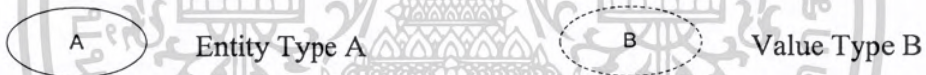
รูปที่ 2.1 แสดงสัญลักษณ์ของ Entity และ Value
