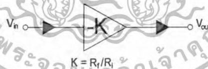
รูปที่ 4.5 บล็อกไดอะแกรมของวงจรขยายสัญญาณแบบกลับเฟส
