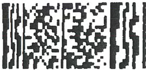
รูปที่ 5.6 ตัวอย่างของภาพที่ได้จากการวาร์ปภาพต้นแบบในมุมมอง Perspective ซึ่งได้ผลไม่ดี
