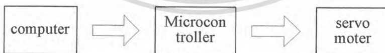
รูปที่ 1.1 บล็อกไดอะแกรมการทำงานทางด้านฮาร์ดแวร์
