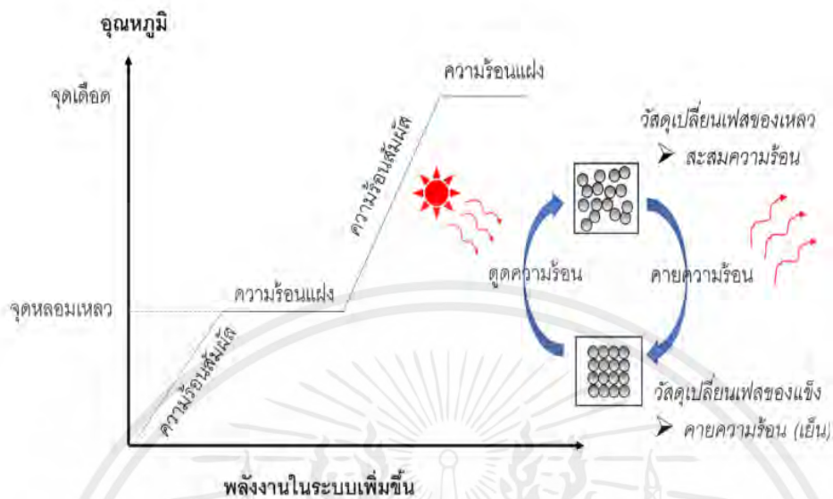
รูปที่ 2.7 ลักษณะและการทำงานของวัสดุเปลี่ยนสถานะ
