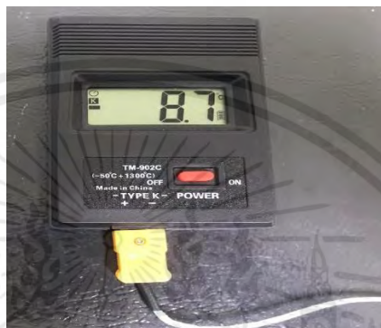
รูปที่ 3.11 การต่อสาย Thermocouple เข้ากับตัวอ่านค่าอุณหภูมิ (thermometer)
