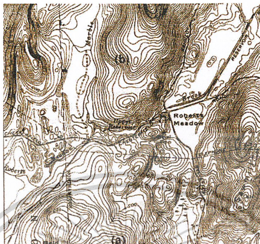
ภาพที่ 3.15 เส้นระดับและแผนที่แสดงเส้นระดับ
