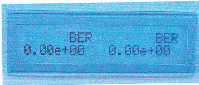
รูปที่ 4.16 ค่า Bit error rate ที่ได้จากการนำจำนวนบิตที่ผิดพลาดหารจำนวนบิตทั้งหมดที่ส่งไปเมื่อจำนวนบิตที่ผิดพลาดเป็นศูนย์
