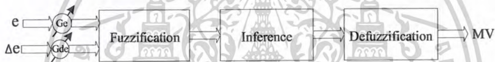
ภาพที่ 4.9 โครงสร้างของตัวควบคุมแบบพีซีซี
