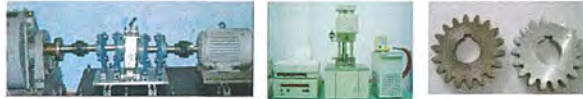
ชุดทดสอบเฟือง เครื่องวัดความหนืดแบบแกนหมุน เฟืองทดสอบ ชนิด ทรงแบน, น้ำมันทูตริ นวาลแก๊ว, บีเยะ นิลละอ, อคิเคช จันทพันธ์
