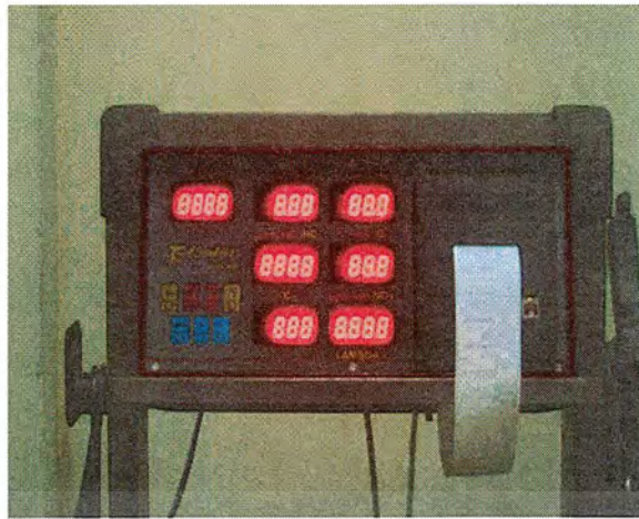
รูปที่ 4.4 แสดงเครื่องวัดมลภาวะ
