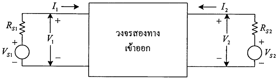
รูปที่ 4.2 วงจรสองทางเข้าออกที่มีแบบจำลองของแหล่งกำเนิดที่อยู่
