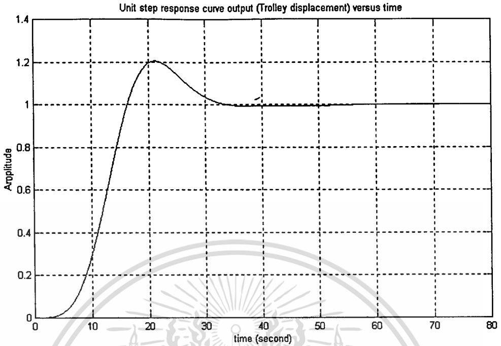
รูปที่ 6.13 ผลของ output ต่อ unit step reference input r(t) โดยการวางโพลดังสมการ (6.7)
