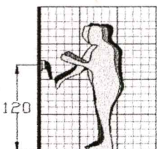
ภาพที่ 4.189 รูปแบบ ระยะห่าง และตำแหน่งปุ่มควบคุมสำหรับคนชรา
