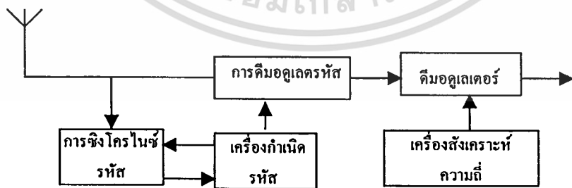
รูปที่ 2.4 บล็อกไดอะแกรมแสดงการทำงานของเครื่องรับของระบบแบบโคเร็คทีแคว้นซีดีเอ็มเอ
