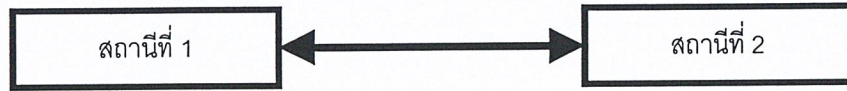
รูปที่ 2.21 แสดงการส่งผ่านแบบสองทิศทางแต่ต่างเวลากัน (Half-Duplex)
