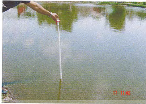
รูปที่ 4.9 การเก็บตัวอย่างน้ำจากบ่อเลี้ยงกุ้ง
