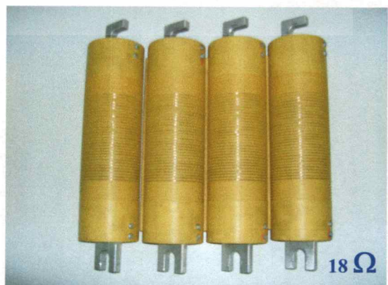
รูปที่ 3.15 Tail Resistors ที่ประกอบสร้างเสร็จสมบูรณ์ (ชุด 13 Ω และ 18 Ω)
