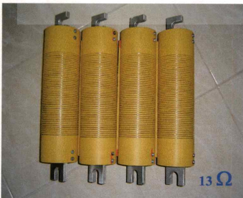
รูปที่ 3.15 Tail Resistors ที่ประกอบสร้างเสร็จสมบูรณ์ (ชุด 13 Ω และ 18 Ω)
