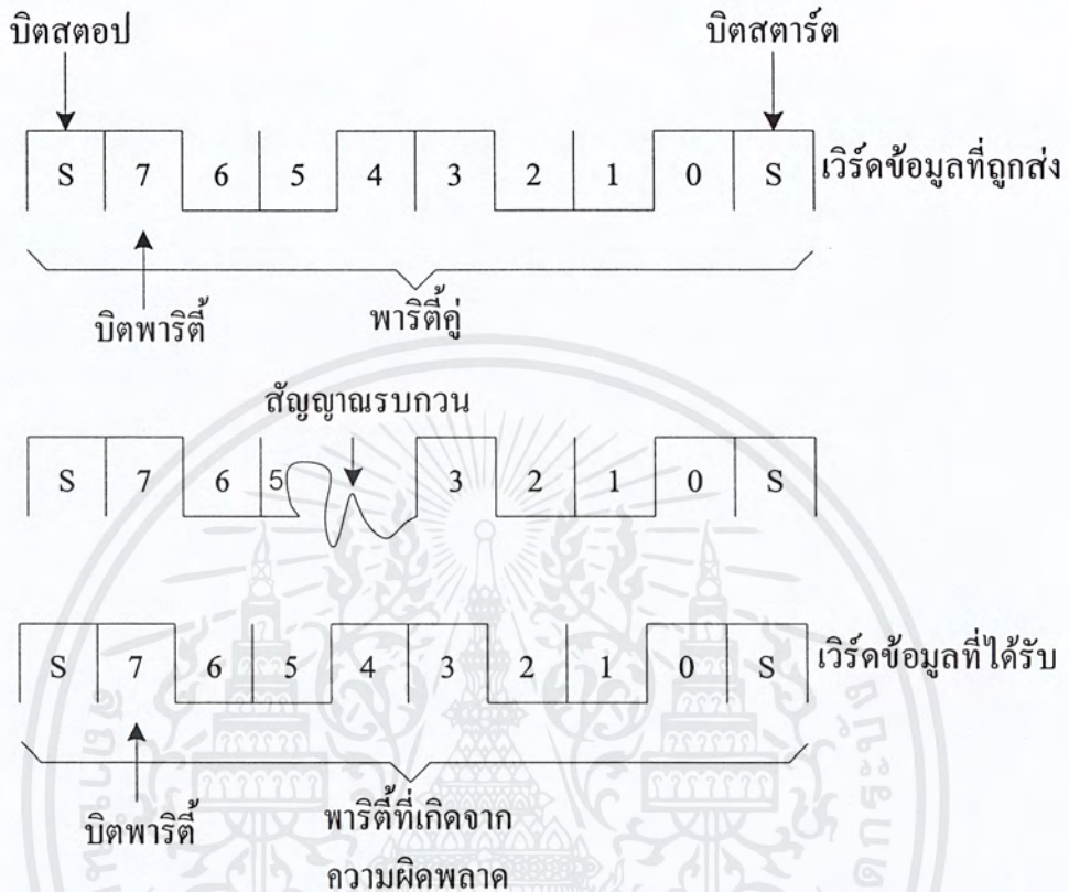
ภาพที่ 2.29 แสดงการใช้บิตพาริตีเพื่อตรวจสอบความผิดพลาดในการโอนย้ายข้อมูลแบบอนุกรม
