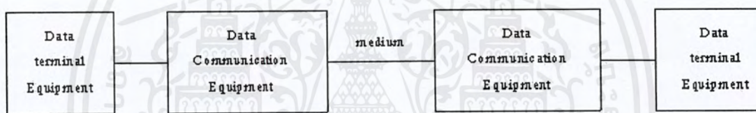
ภาพที่ 2.15 แผนผังการทำงานของระบบการสื่อสารแบบจุดต่อจุด (Point to Point)
