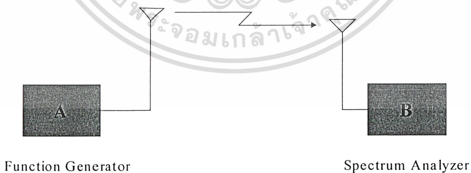
รูปที่ 4.18 การต่ออุปกรณ์ที่ทดสอบอัตราขยายของสายอากาศ
