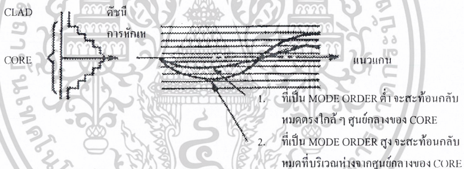
รูปที่ 2.21 แสดงลักษณะการเดินทางของแสงใน GI FIBER
