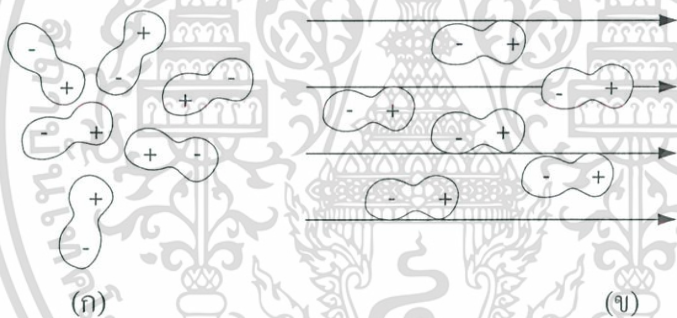
รูปที่ 1.5 ลักษณะของ โมเลกุลแบบมีขั้ว (ก) เมื่อไม่อยู่ในสนามไฟฟ้า (ข) เมื่ออยู่ในสนามไฟฟ้า
