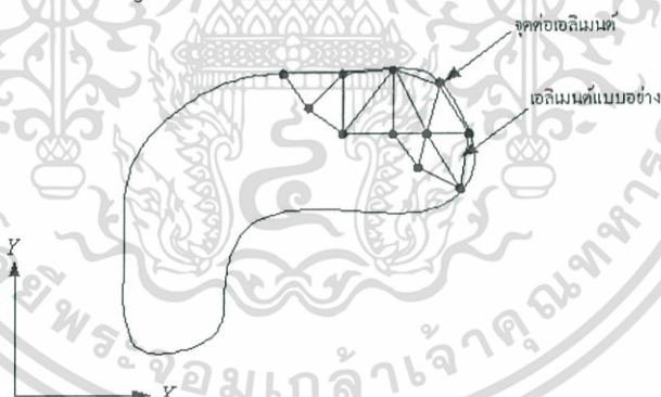
รูปที่ 3.8 การแบ่งรูปร่างลักษณะของปัญหาออกเป็นเอลิเมนต์ต่างๆ
