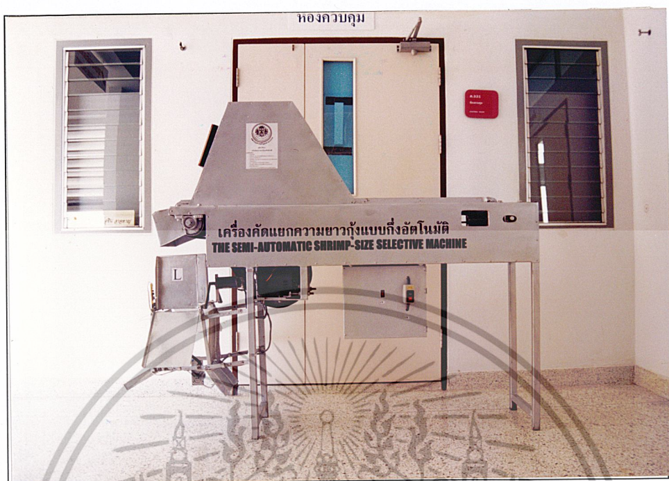
รูปที่ ก.7 ภาพด้านข้างของเครื่องคัดแยกความยาวกุ้งแบบกึ่งอัตโนมัติ
