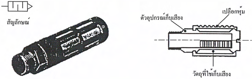
รูปที่ 2.62 โครงสร้างอุปกรณ์เก็บเสียงชนิดใช้แรงเสียดทาน
