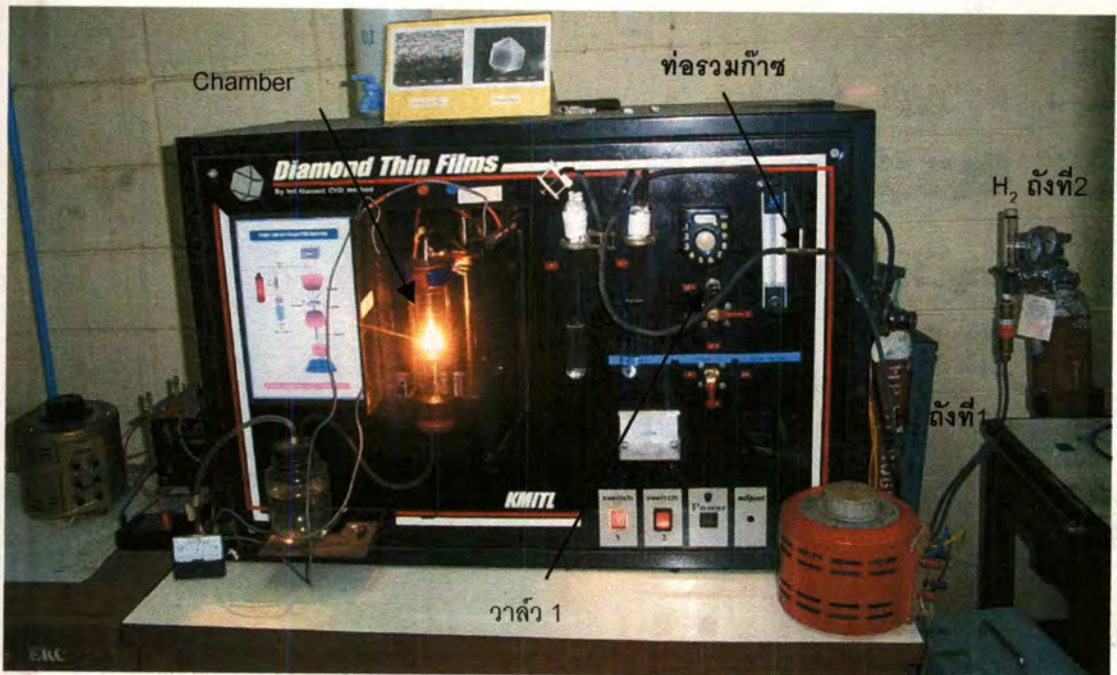
รูปที่ 3.2 เครื่องมือสังเคราะห์ฟิล์มเพชรด้วยวิธี HFCVD
