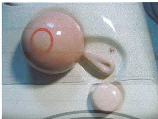
ภาพประกอบที่ 116 แสดงส่วนวาล์วเปิด-ปิดน้ำเข้าสู่เครื่องซัก และส่วนใส่สารซักฟอก
