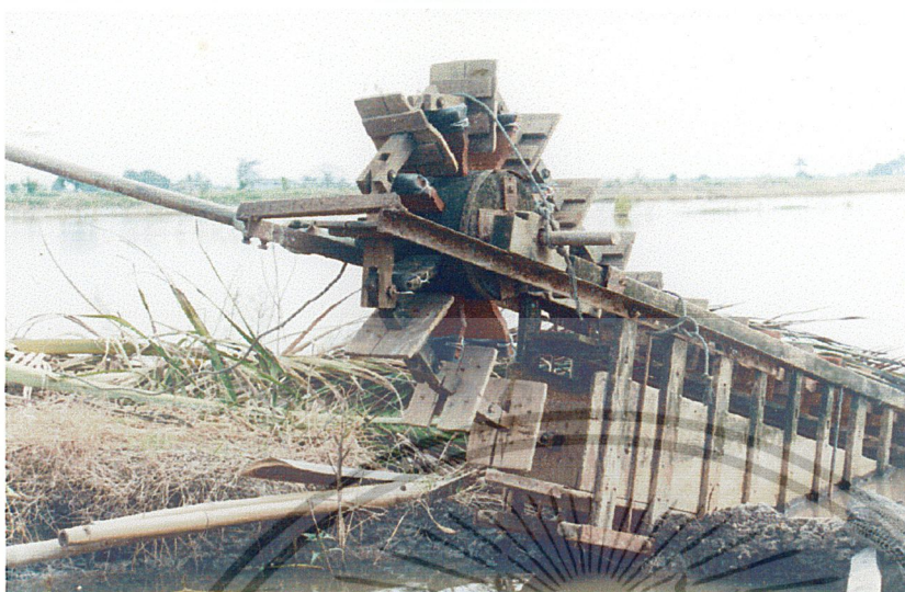
กลไกของระหัดวิดน้ำซึ่งสร้างด้วยไม้ ภาพจาก อ.คลองสวน จ.สมุทรปราการ
