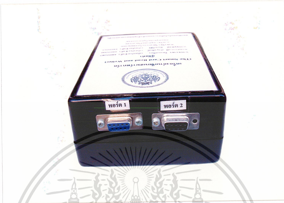
รูปที่ ก.2 ภาพด้านหลังของเครื่องอ่าน-เขียนสมาร์ทการ์ด
