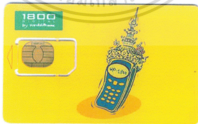
รูปที่ 2.3 สมาร์ทการ์ดแบบที่มีหน่วยประมวลผลกลางอยู่ในตัว
