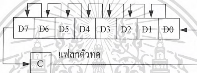
รูปที่ 2.13 การหมุนข้อมูลไปทางซ้ายผ่านแครี่
