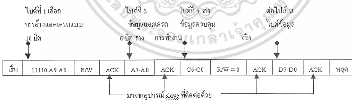
รูปที่ 2.12 รูปแบบของข้อมูลที่ใช้ติดต่อกับอุปกรณ์บัส I2C เมื่อใช้การอ้างถึงแบบ 10 บิต
