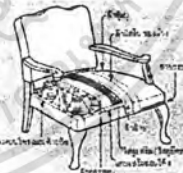
- รูปแบบโครงสร้างที่ใช้ระบบสปริง ร่วมกับวัสดุหุ้มบุ
