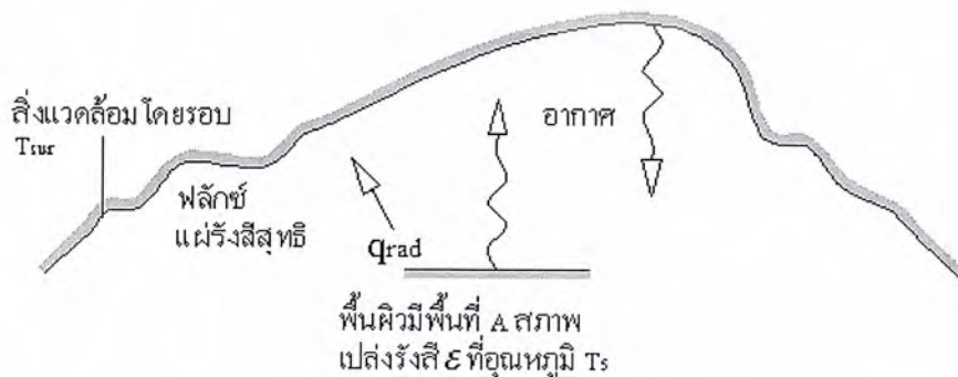
รูปที่ 2-4 การแผ่รังสีแลกเปลี่ยนความร้อนระหว่างพื้นผิวหนึ่งกับสิ่งแวดล้อมโดยรอบ
