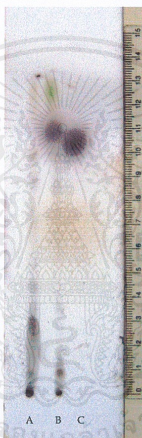
รูปที่ 11 แถบสารบนโครมาโตกราฟีแผ่นเคลือบบาง หลังจากพ่นกรดซัลฟิวริกเข้มข้น แถบ A สารสกัดจากแคลลัส แถบ B สารสกัดจากต้น แถบ C สารละลายมาตรฐานยูจีนอล
