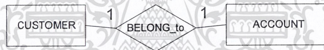
รูปที่ 4-7 แสดงความสัมพันธ์แบบ One to One
