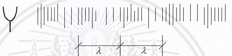
รูปที่ 2-9 แสดงคลื่นเสียงการอัดและขยายของโมเลกุลอากาศ
