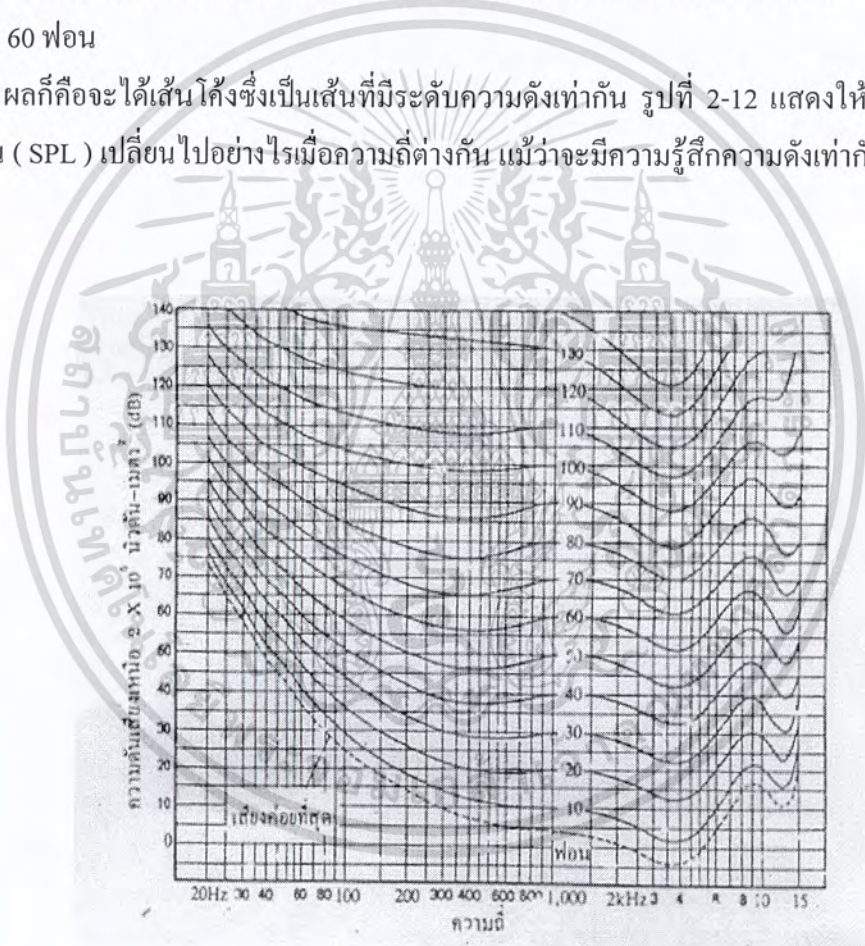
รูปที่ 2-12 เส้นโค้งของระดับความดังเท่ากันสำหรับเสียงบริสุทธิ์
