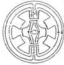
รูปที่ 3.6 แสดงตำแหน่งสมดุคย์ เมื่อเฟสใดเฟสหนึ่งของสเตปมอเตอร์ถูกกระตุ้น
