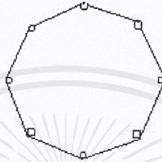
รูปที่ 2.34 แสดงการเชื่อมต่อแบบ Ring
