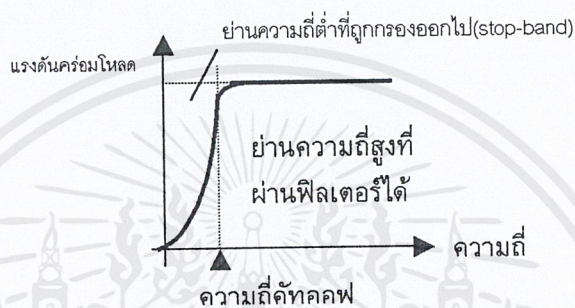
รูปที่ 2.11 กราฟแสดงการทำงานของไฮพาสฟิลเตอร์
