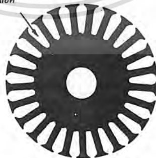
รูปที่ 3.3 แสดงร่องสลอตสำหรับฝังขดลวดตัวนำในแกนเหล็กอาร์เมเจอร์
