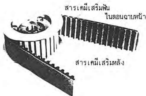
รูปที่ 5.3 สายพานล้อยกที่มีรูปตัดของฟันเป็นรูปครึ่งวงกลม และขนาดโคบนสายพาน แต่ขนาดเล็กบนล้อขับ
