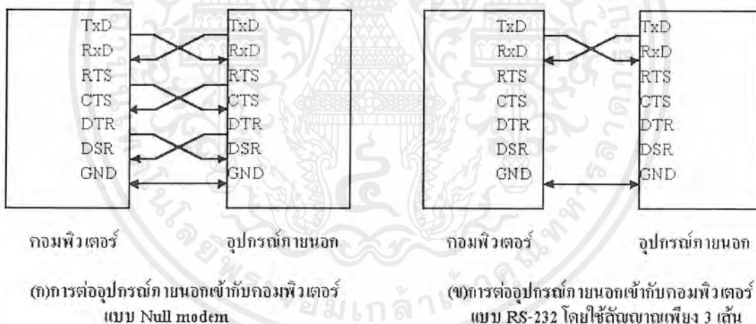
รูปที่ 2.28 การต่ออุปกรณ์ภายนอกกับพอร์ตอนุกรมของคอมพิวเตอร์ในลักษณะต่าง ๆ
