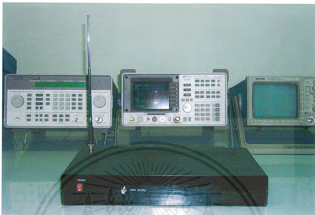
รูปเครื่องรับของโมเต็มไร้สายความเร็ว 64 กิโลบิตต่อวินาที
