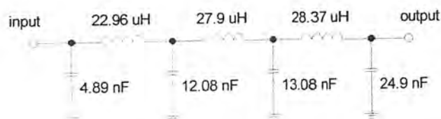
รูปที่ 3.7 วงจรกรองความถี่ต่ำผ่านชนิดเกาส์เซียนความถี่คัตออฟ 320 กิโลเฮิร์ตซ์
