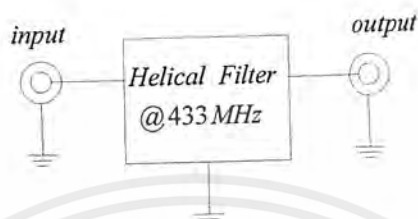
รูปที่ 3.20 เฮลิคอลลฟิลเตอร์ (Helical Filter) ที่ความถี่กึ่งกลาง 433 เมกะเฮิร์ตซ์
