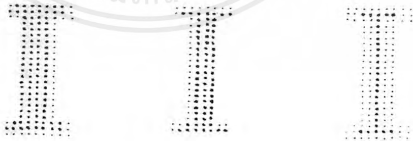
รูปที่ 3.4 a. การทำขั้นตอนที่ 1 b. การทำขั้นตอนที่ 2 c. ผลการทำให้บาง
