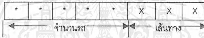
รูปที่ 5.5 แสดงเฟรมข้อมูลที่ได้รับเข้าทางพอร์ต 8255 ของตัวแม่ข่าย
