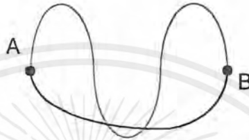
รูปที่ 2.2 การวาดสัญญาณของสโคป (แสดงเส้นสะบัดกลับ)
